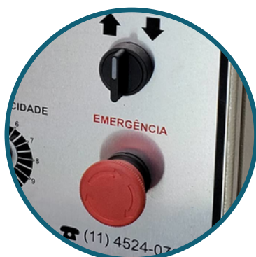
Botão de emergência
